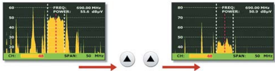
Painamalla 'YLÖS' näppäintä kahdesti, laite asettaa referenssitason 60:stä 80:een dBµV.
