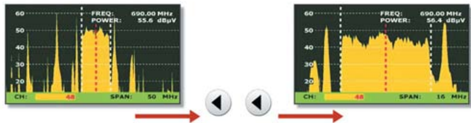
Painamalla 'VASEN' näppäintä kahdesti, laite asettaa pyyhkäisyalueeksi 50:stä 16:een MHz.
